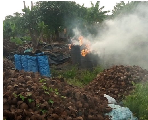
Photo 5 : Un tas de coque en combustion pour produire du charbon
