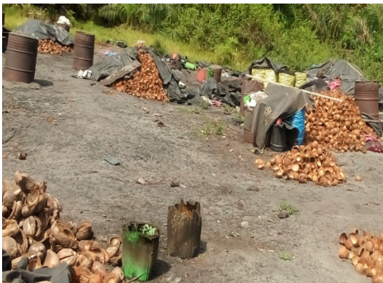
Photo 4: Des petits fûts dispersés sur un site servant à brûler la coque
