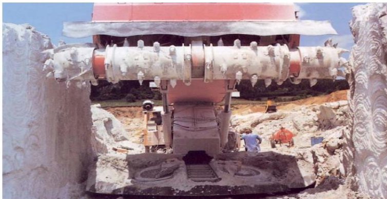
Figure N°6 – Vue extérieure de l'organe de travail de la fraiseuse minière Voest-Alpine Bergtechnik
