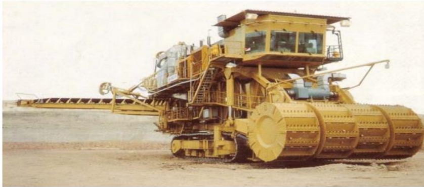
Figure N°9 - Fraiseuse à roues rotatives KSM-2000R
