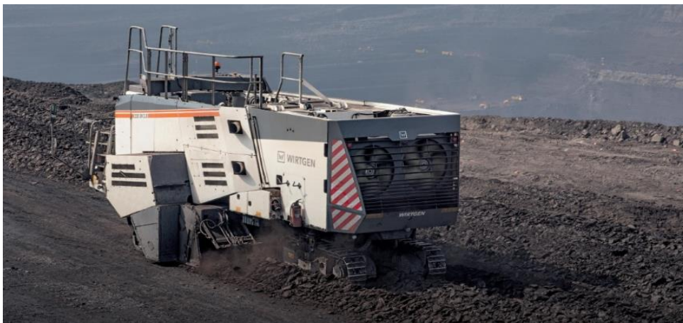
Fig.15 - Déversement par l'arrière de la fraiseuse pour former des andains
