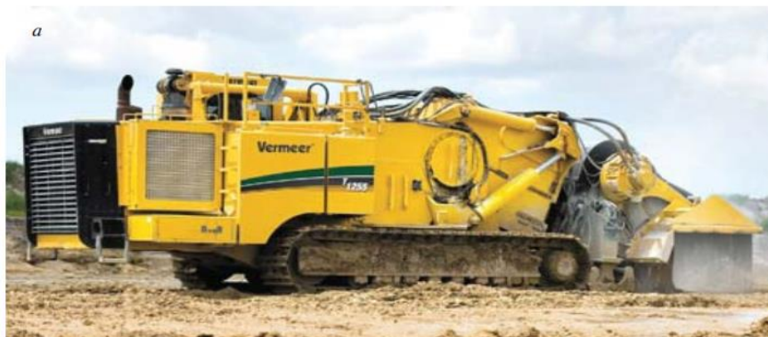
Figure N°4 - Fraiseuse de rippage de la marque Vermeer T1255 TL : a- vue extérieure de la fraiseuse ; b- l'organe de travail de la fraiseuse
