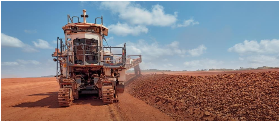
Figure N°14 - Déversement latéral en pile
