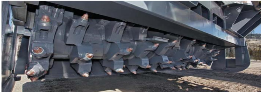
Figure N°3 - Vue extérieure de l'organe de travail (tambour de fraisage) d'une fraiseuse à tarière (Wirtgen 4200 SM)
