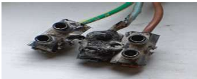
Fig. D'un court-circuit résistif
